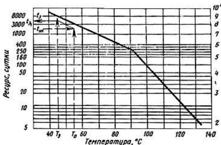
3. Определяют для  $T_0$  при заданной наработке  $t_{н1}$  соответствующее эквивалентное время при температуре  $T_3$ : из точек  $T_0$  и  $t_n$  проводят прямые, соответственно параллельные осям температуры и ресурса. Из точки пересечения этих прямых проводят прямую, параллельную линии критерия работоспособности, до пересечения с вертикальной прямой  $T_3$ ; напротив точки пересечения на оси ресурса находят время  $t_{31}$ .
